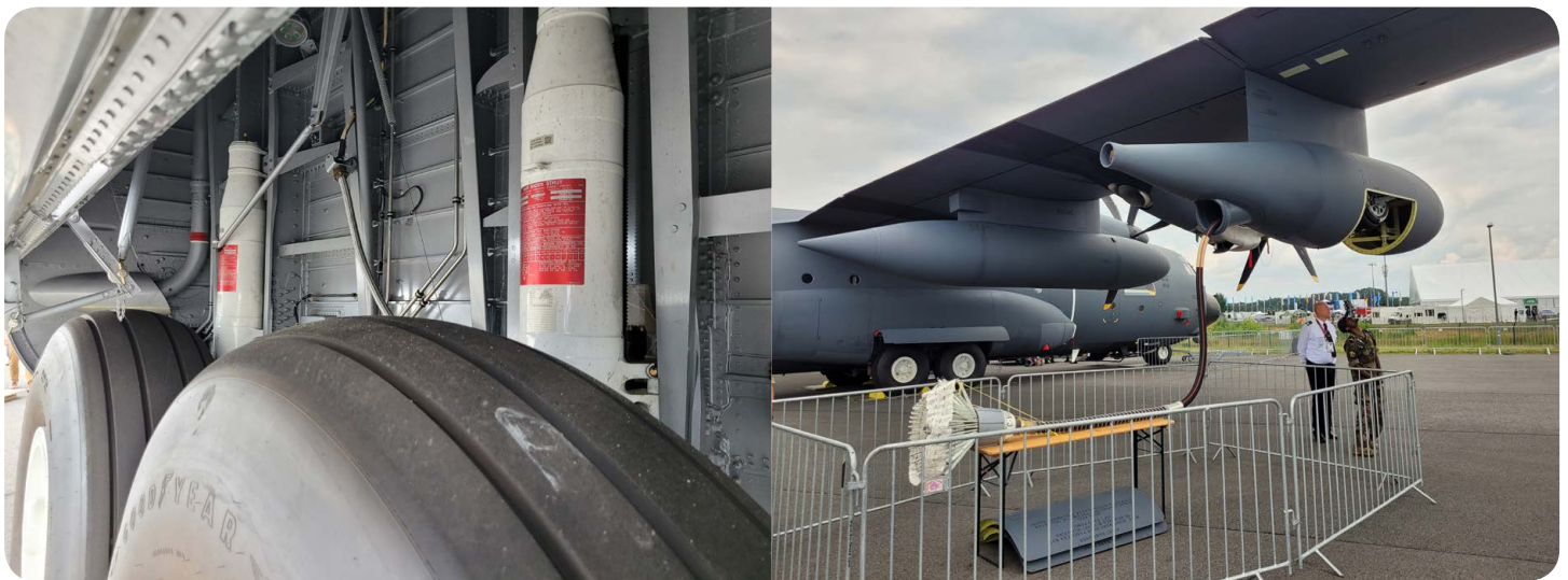
Links: Fahrwerk der C-130 Rechts: Schlauch mit Fangtrichter für die Luftbetankung
