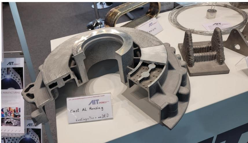
Gegossener E-Motor aus Aluminium mit WAAM-gefertigter Decke
