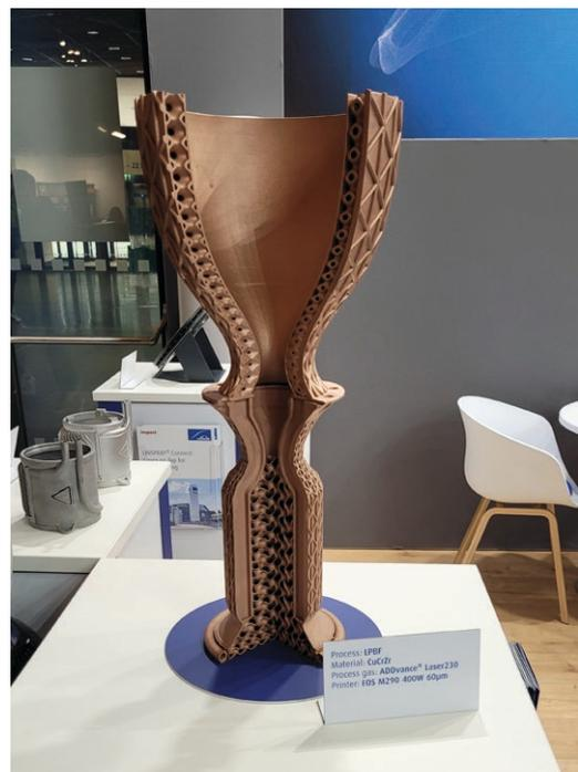
Raketentriebwerk aus Kupfer von Linde
