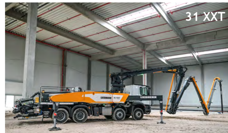
Die LiDriveln Funktion ermöglicht das betonieren in niedrigen Hallen.
